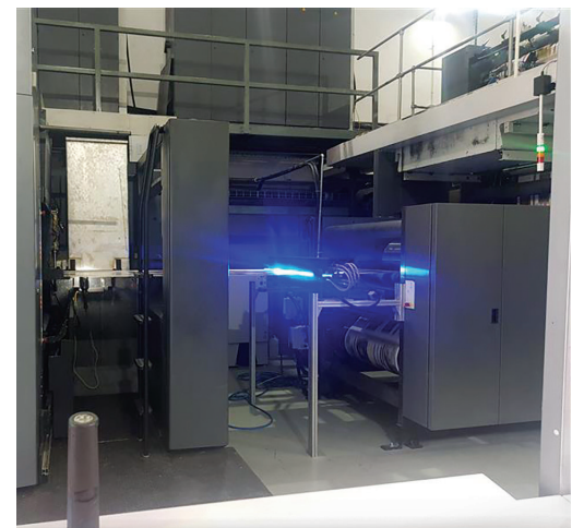
Beispiel einer auf AMS Spectral LED UV umgerüsteten Web-Offset Druckmaschine
