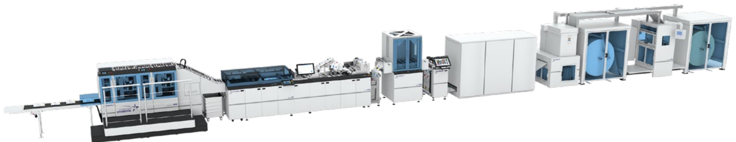
Die neue Hunkeler Starbook-Webfolder-Buchlösung mit Medienwechsler RX8 und Bahnfalzer WF8 soll sich perfekt für Softcover- oder Hardcover-Buchblocks und Kataloge auf Basis von 4-Seiten-Signaturen eignen.
