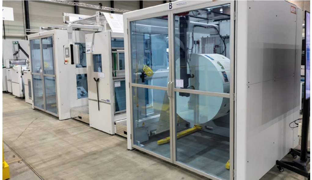
Der Medienwechsler RX8 speiste auf der Messe die neue Starbook-Webfolder-Buchlösung und ermöglichte so einen von der Druckmaschine unterstützten automatischen Nonstop-Rollenwechsel mit verschiedenen Papieren bei laufender Maschine.
