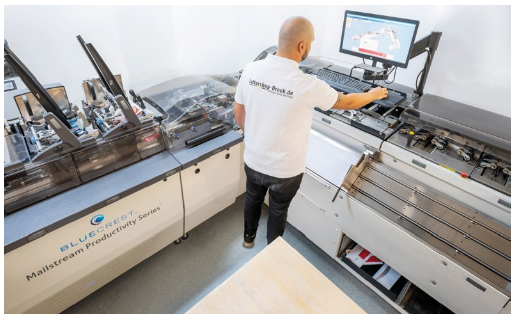
... fünf dieser robusten Hochgeschwindigkeits-Falz- und Kuvertiermaschinen des Herstellers Bluecrest. Gesamtkapazität: Über 100.000 Kuvertierungen pro Stunde.
